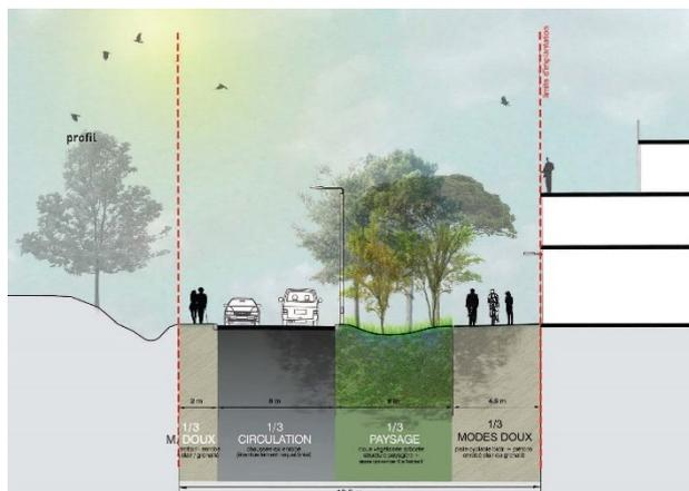
Profil type des voies de dessertes principales de l'opération
